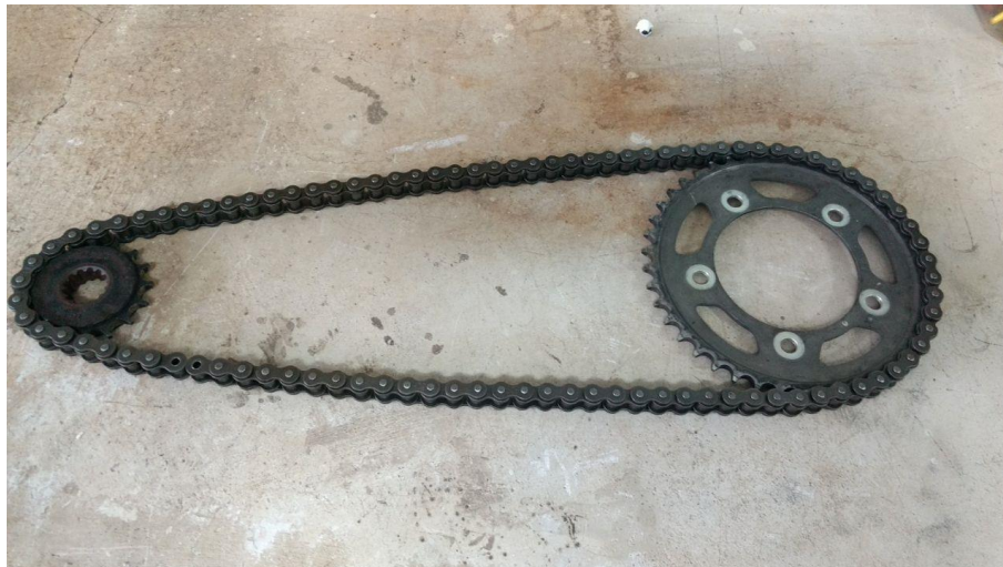
Figura 17: Conjunto pinhão, corrente e coroa original da Hornet utilizado anteriormente pela equipe
