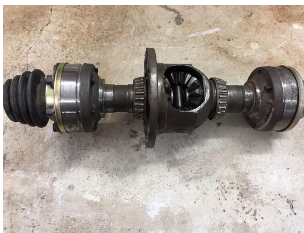
Figura 18: Conjunto de diferencial, rolamentos e acopladores do Gol G4 atualmente utilizados pela equipe
